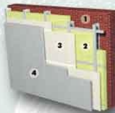
Рис. 3 Пароизоляция стены с внутренним утеплением
