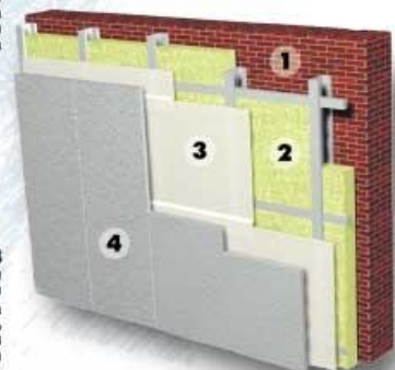
Рис. 3 Пароизоляция стены с внутренним утеплением
