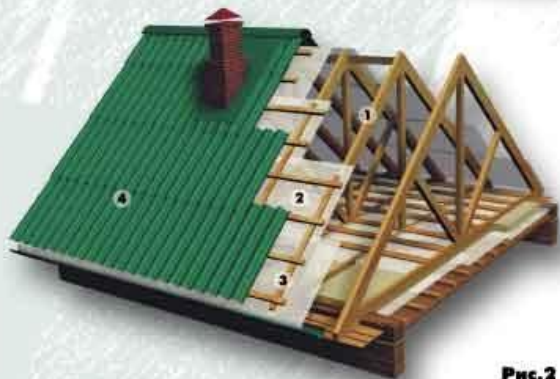
Рис. 2 Кровля с неотапливаемым чердачным помещением
