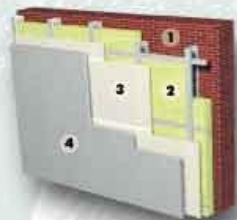
Рис. 3 Пароизоляция стены с внутренним утеплением
